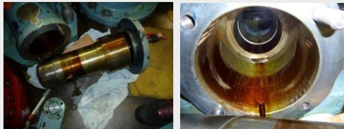
Verriegelungsbolzen der Turbine mit harzartigem Belag
